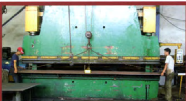
Plieuse 140T - 4m - épaisseur 8 mm
