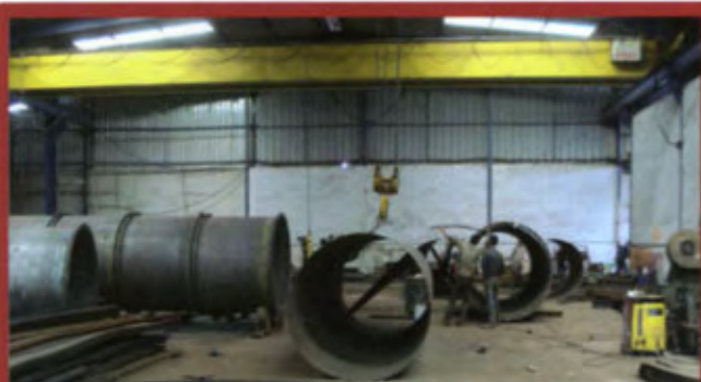
Atelier avec Pont Roulant 10 et 20 Tonnes
