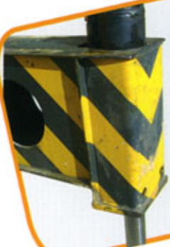
Réparation de vérin de stabilisation - grue
