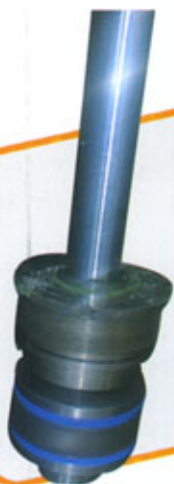
Chromage de tiges de vérin jusqu'au diam:300 x L:3m
