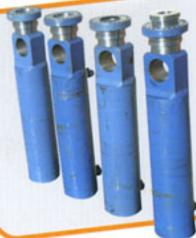
Réparation de vérin de rouleuse de tôle forte épaisseur
