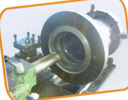
Contrôle de cylindricité de vérin
