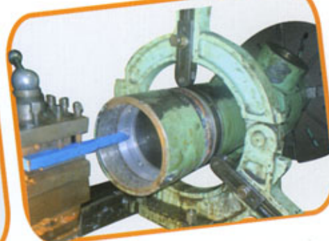
Usinage de vérin de laminoir
