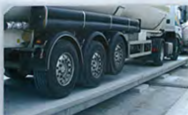
ROC : Pont-basculle modulaire béton, installation hors-sol
