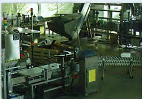
Contrôle de remplissage en ligne, éjection des non conformes et feed back vers la doseuse.
