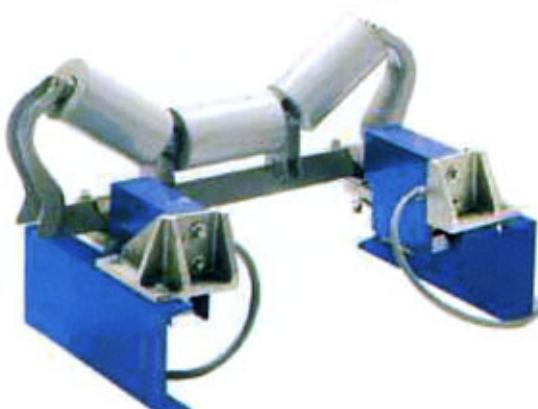
Le châssis peseur modéle IDEA comprend suivant la largeur de la bande transporteuse, un (1) ou deux (2) << Blocs peseurs >> placé dans le convoyeur par une poutre de support ou par deux équerres de fixation latéraux. Chaque bloc peseur comporte un capteur de force et une protection de surcharge.
