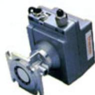
Le Granuflow DTR 131 est un détecteur sans contact, idéal pour surveiller l'écoulement et le non-écoulement des matières solides dans les conduites, les canaux, les aéroglyseurs, les points de transfert des chargeurs vibrants, les bandes transporteuses et les élévateurs à godet.
