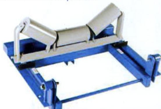
Le châssis peseur modéle 10-20 a un bâti mobile très rigide qui supporte le rouleau peseur. Ce bâti interne est accroché à trois points ; Deux points pivotants et un capteur de force. Les points pivotants, une paire de tourillons, compensent les forces horizontales créées par la bande.
