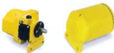
Normalement, le capteur de vitesse est couplé à l'axe prolongé du tambour mené par la bande transporteuse; ce qui évite l'influence de dérapage au tambour motorisé sur la mesure. Pour les installations dans lesquelles cette solution n'est pas applicable, on peut choisir une exécution du capteur de vitesse avec un contact de proximité placé devant le tambour mené. De cette façon la vitesse mesurée est toujours réelle.
